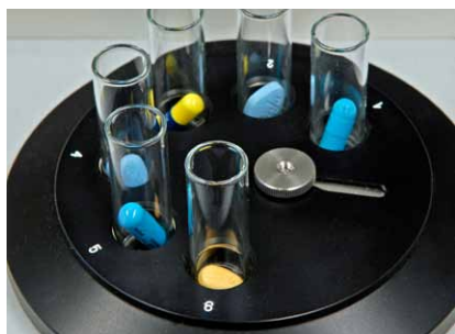
Kapseln und Tabletten werden mit NIR-Spektroskopie direkt gemessen.
