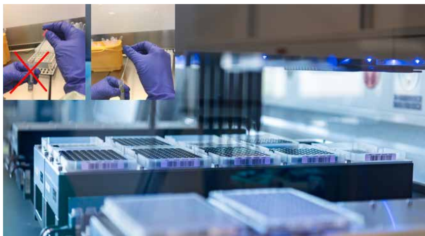
Figure 2. Automatisation et qualité de la phase pré-analytique pour la PCR SARS-CoV-2: Cette figure présente le robot Hamilton disponible au laboratoire de microbiologie du CHUV à Lausanne, qui garantit une excellente reproductibilité et une bonne traçabilité grâce à un système de barres-codes. Ce robot permet de préparer des plaques de 384 puits pour tester par PCR plus de 100 agents pathogènes différents. Photographie de Heidi Diaz (CHUV, Lausanne). L'encadré montre des écouvillons utilisés dans des centres de tests en mars 2020. En raison de la pénurie de matériel, de large écouvillons (à gauche) ont été utilisés au lieu des écouvillons nasopharyngés (à droite), avec comme corollaire une perte de sensibilité et des blessures des muqueuses nasales (veuillez noter l'aspect sanguinolent de l'écouvillon de droite). Photographie de Katia Jatton (CHUV, Lausanne).
